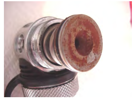
• Kolben mit Dreck
