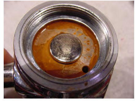
• Rost und Wasser in 1. Stufe
