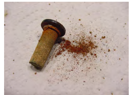
• Rost – Sinterfilter war dicht
