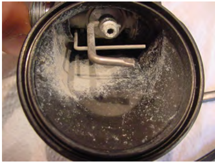
• Aluminiumstaub in 2. Stufe
