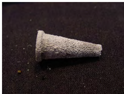
• Sinterfilter voll Alustaub
