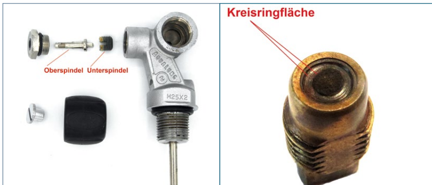
Abbildungen 7 und 8 links: Ventil in Einzelteile zerlegt, rechts: Unterspindel (Fotos Ralf Krause)
