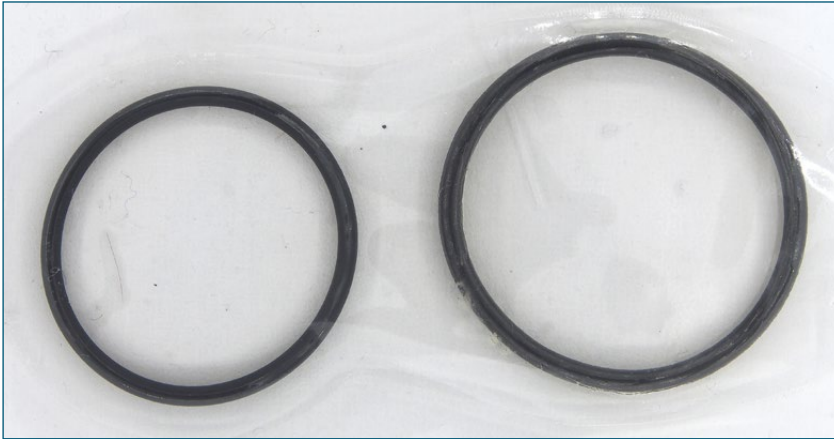
Abbildung 33 Aufgequollene O-Ringe durch falsches Fett (Foto: Ralf Krause).
