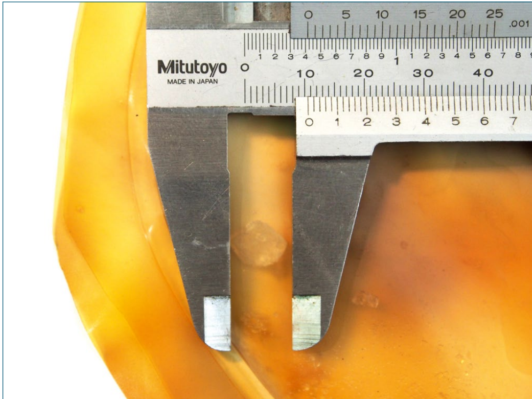
Abbildung 32 Salzkristalle in einer Jacketblase (Foto: Ralf Krause).
