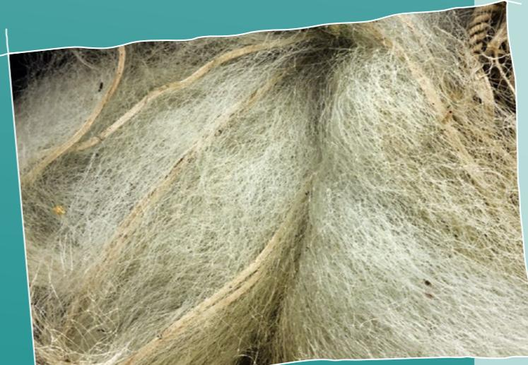
Ausgediente Stellnetze sind sauber und für das Nylonrecycling geeignet.
